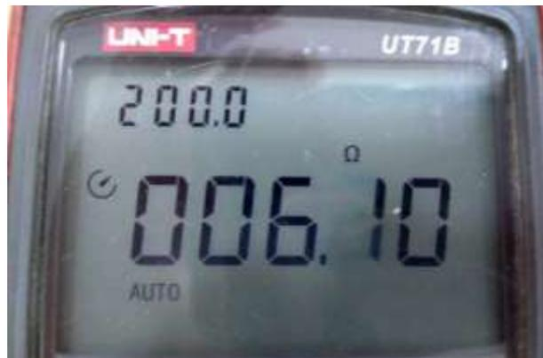
Figura 35. Resistencia del electrodo
