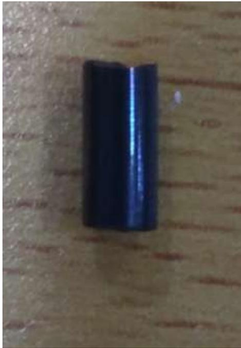
**Figura 24. Electrodo de Aerogel de carbono**
