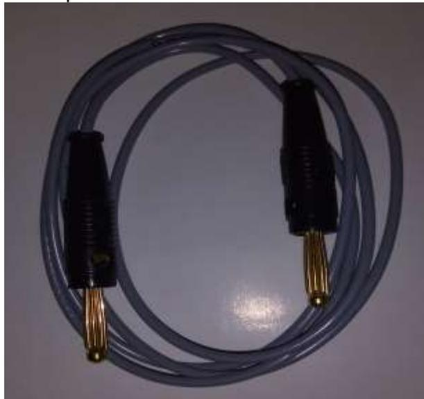
**Figura 29. Línea de conexión electrodo**
