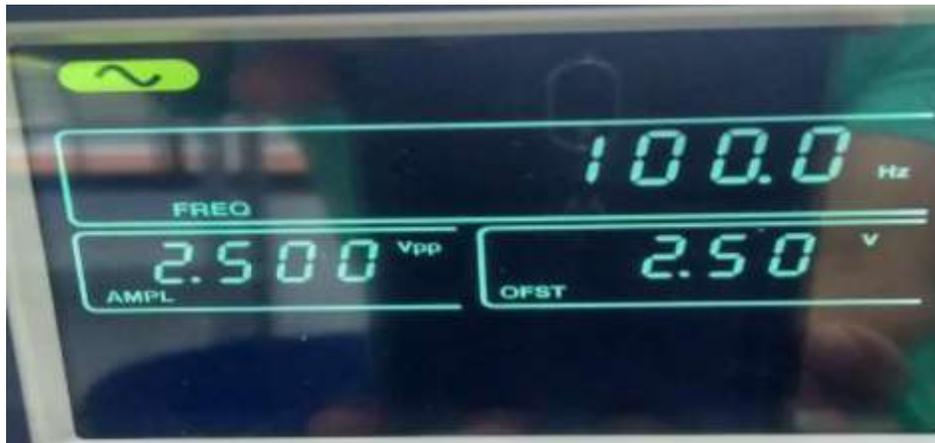
Figura 38. Señal de mayor frecuencia al electrodo
