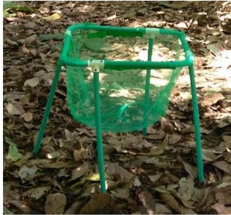
Ilustración 1 Canasta colectora de hojarasca
