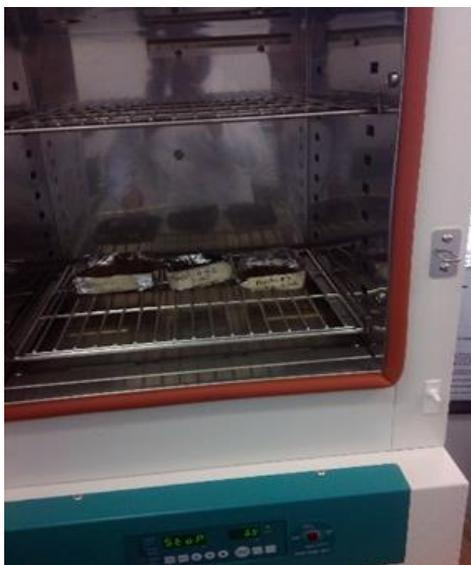
**Anexo 3.** horno de laboratorio, se realizó el secado de las muestras de corteza.
