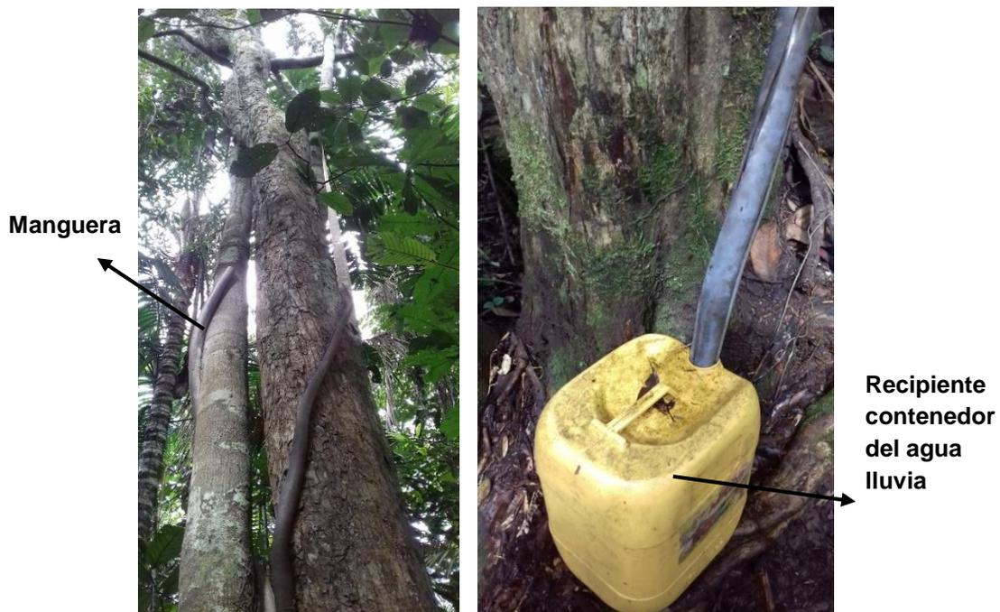
**Fig. 6.** Imágenes de los collarines instalados para medir la precipitación translocada. **Fotos:** Vitar-Mendoza, J.J. (2016)
