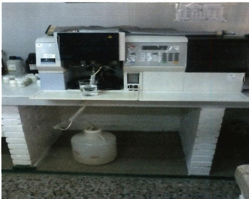
Anexo 15. Equipo para medición del pH. (pH-meter E. 520)
