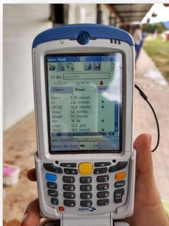
Imagen 21. Medición de gases sanguíneos mediante el sistema de análisis de sangre (EPOC).
