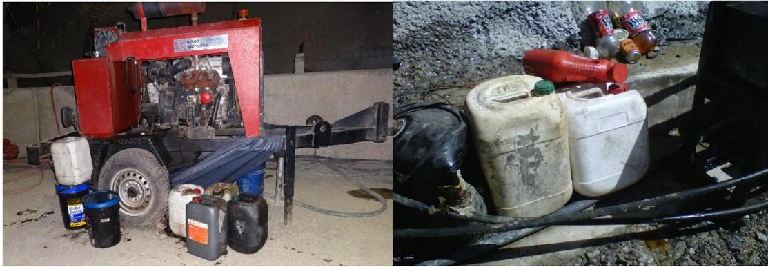
Figura 7. Inadecuado almacenamiento y rotulación
