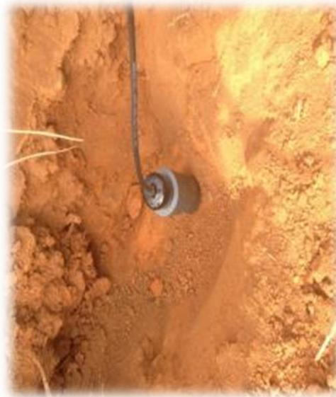
Sonda SM150 conectada al sensor HH2.
