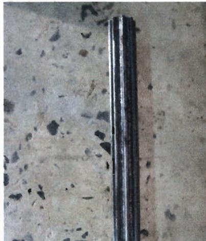
Figura 17. Eje estriado con deformaciones sobre ranuras.
