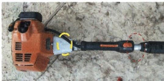
Figura 14. Unión inferior telescopio-motor: Círculo Amarillo; engrane telescopio motor: Círculo Rojo; soporte balinera inferior y unión con armazón del telescopio.
