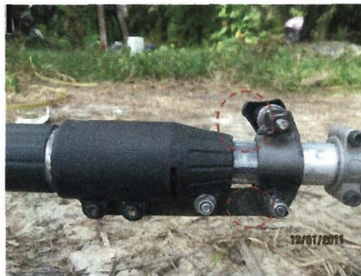
Figura 10. Abrazadera superior con soldaduras rotas.
